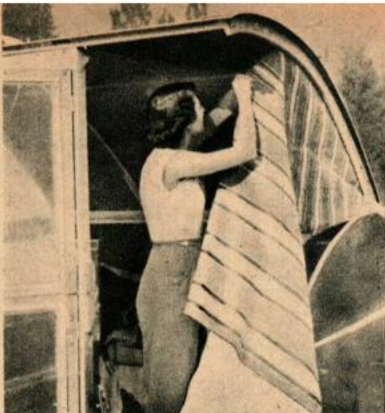
Les murs en toile entourent la cuisine et se fixent avec des ceilllets et des boutons tournants. Prendre une toile épaisse.
