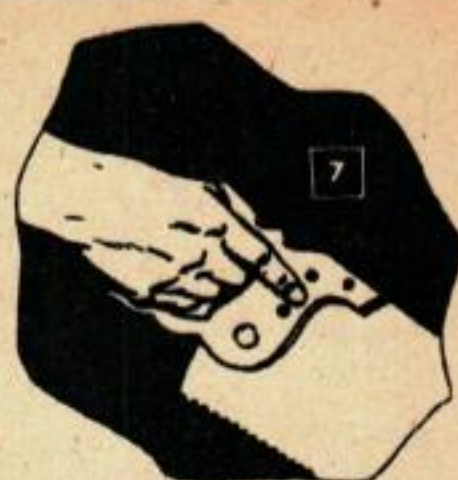
METTRE L'INDEX SUR LE CÔTÉ DE LA POIGNÉE
