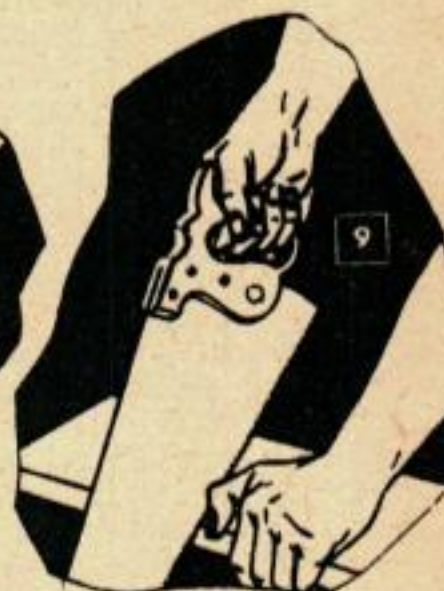
GUIDER LA LAME AVEC LE POUCE AU DÉBUT DU SCIAGE
