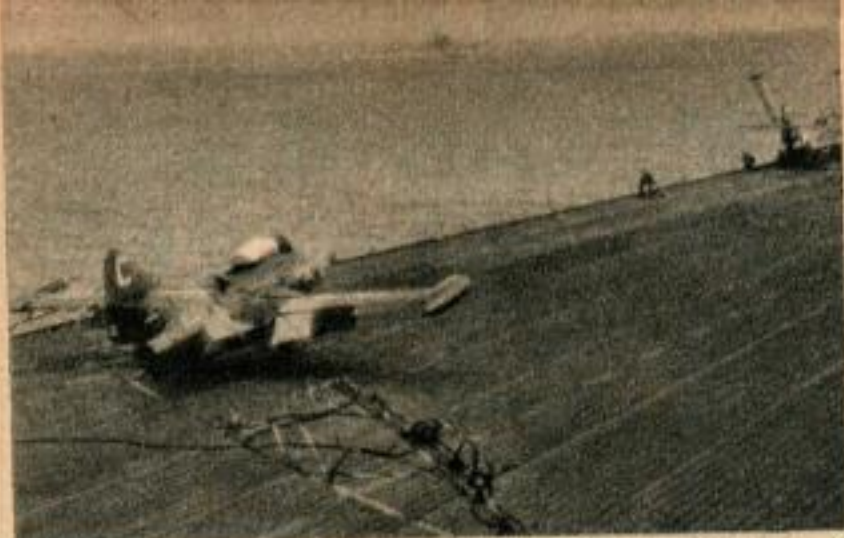
Ces photos représentent un accident lors de l'entraînement des pilotes sur un porte-avions. Ici, l'avion s'écrase sur une barrière.
