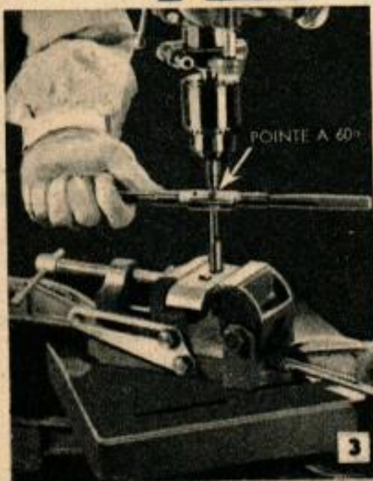
1 Montage pour les taraudages de petits diamètres. On actionne la broche à la main.
