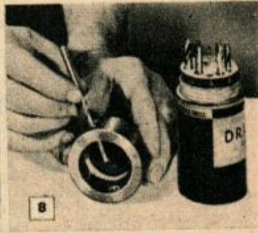
8. Détermination de fortune du diamètre de l'avant-trou en essayant différents forets.
