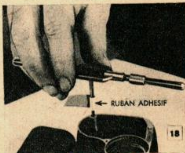
Ruban adhésif utilisé comme limiteur de course.
