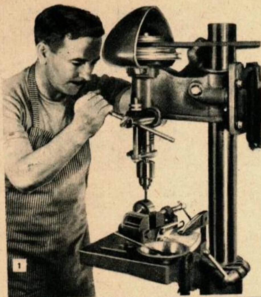
1 Montage pour les taraudages de petits diamètres. On actionne la broche à la main.
