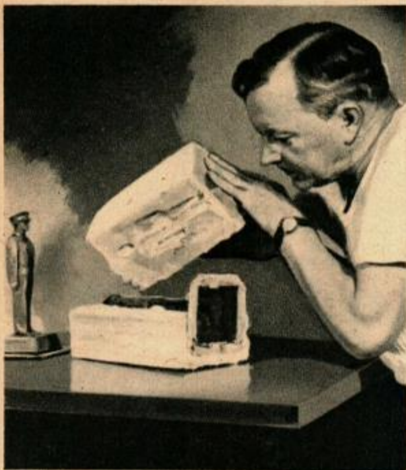
La mise en place du moule en caoutchouc dans le plâtre nécessite de minutieuses précautions. On évite ainsi les déformations du moule qui impliquent des moulages défectueux. Ci-dessous, construction du moule métallique en acier galvanisé mince. Avec dimensions dépendant de celles de la figurine.
