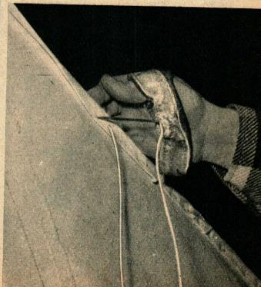
La voile est munie d'armatures en fil d'acier inoxydable cousues à la main. Ci-dessous, les paumelles en cuir très dur servant à pousser l'aiguille.
