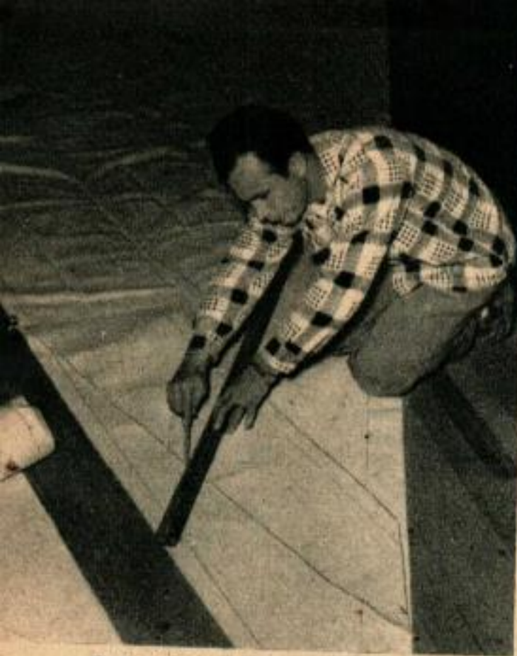
Les coins et le sommet de la voile sont renforcés par des pièces cousues. Ici, l'on mesure les dimensions de la pièce de renforcement du coin. À droite, dès que la voile est cousue, on l'étale sur le sol de l'atelier.
