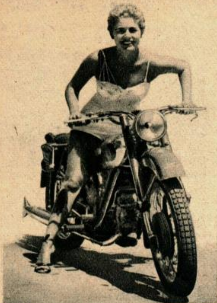
La moto italienne la plus populaire en Amérique est la Guzzi. Le moteur de 500 cm 3 est placé horizontalement.
