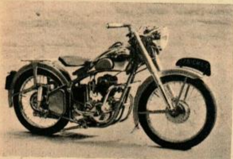
AUTO MOTO : 175 CHL 4, 175 cm 3 , 4 temps, moteur AMC à culbuteurs, 4 vitesses par sélecteur, suspension AR avec correcteur Grégoire.
