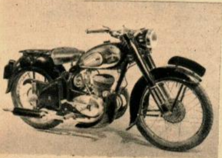
PEUGEOT : 176 TC 4, 175 cm 3 , 2 temps, double échappement, suspension arrière télescopique à tension réglable.
