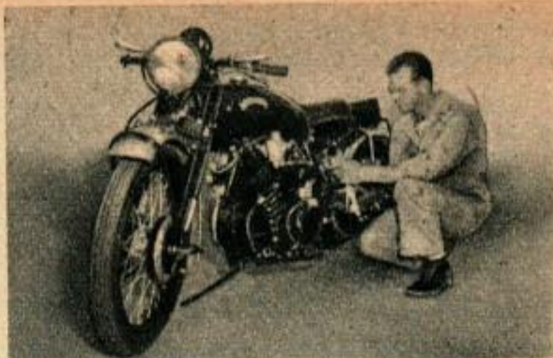
Une des motos les plus rapides du monde est la Vincent (anglaise) de 999,50 cm 3 de cylindrée. Le moteur est suspendu au-dessous et en avant du cadre.
