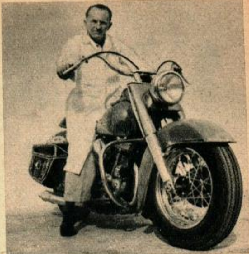
Vue avant de la « Big Twin » Harley Davidson. Notez l'énorme fourche télescopique avant assurant une meilleure tenue de route.
