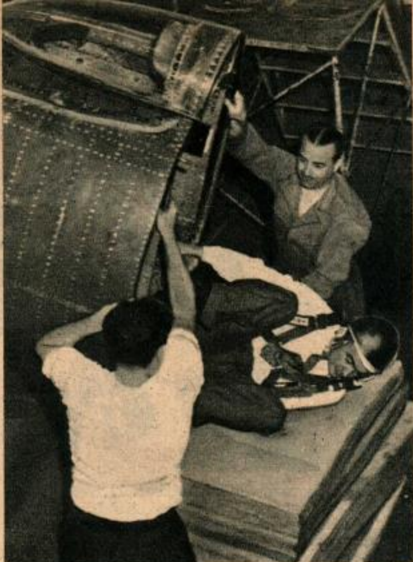
Des ingénieurs reconstituent les conditions dans lesquelles, en cas d'urgence, le pilote serait obligé d'abandonner son «Skyrocket» à nez démontable.
