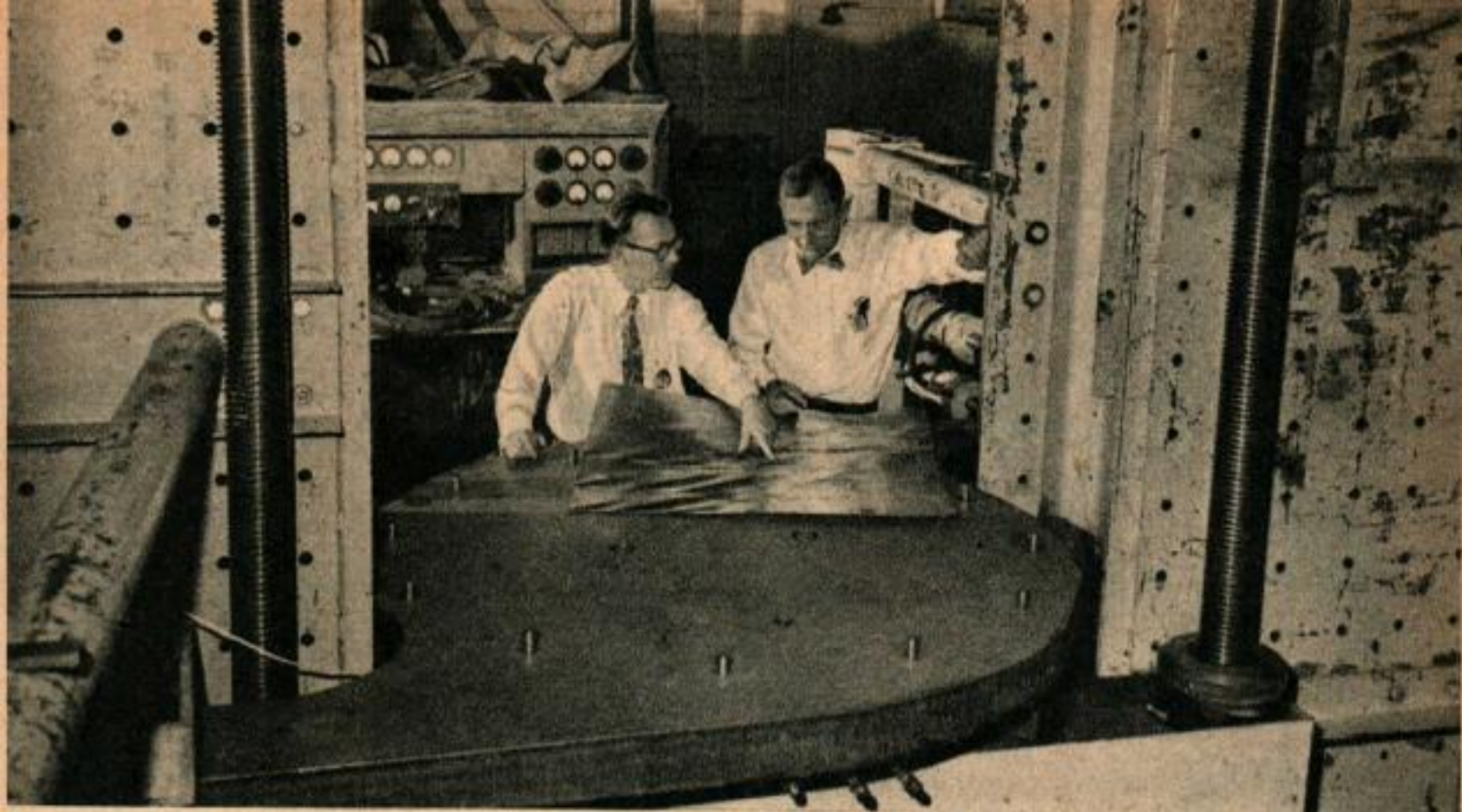
Pour éprouver la force de l'un des nouveaux métaux, l'on glisse une feuille de titane sur une machine capable d'exercer une force de compression et de torsion de 1.125.000 kg.
