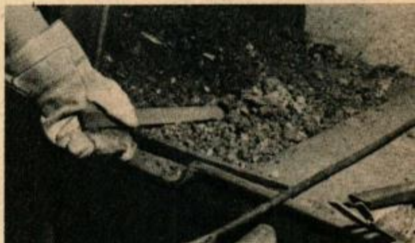
Ci-dessus, première étape de la fabrication du couteau: l'ébauche est chauffée à la forge. Ci-dessous, l'ébauche chauffée est martelée sur l'enclume jusqu'à ce que l'on obtienne une forme pouvant se terminer par meulage.
