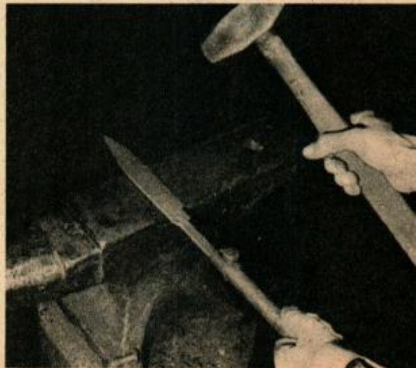
Ci-dessus, première étape de la fabrication du couteau: l'ébauche est chauffée à la forge. Ci-dessous, l'ébauche chauffée est martelée sur l'enclume jusqu'à ce que l'on obtienne une forme pouvant se terminer par meulage.
