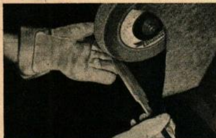
Ci-dessus dégrossissage de l'ébauche sur une meule à gros grain. Ci-dessous, polissage sur buffle ou disque en toile.
