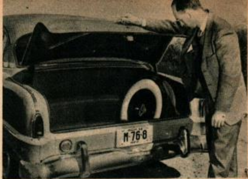
La malle est plus vaste et son couvercle plus large. Notex le bouchon du réservoir d'essence, au-dessus du pare-chocs.
