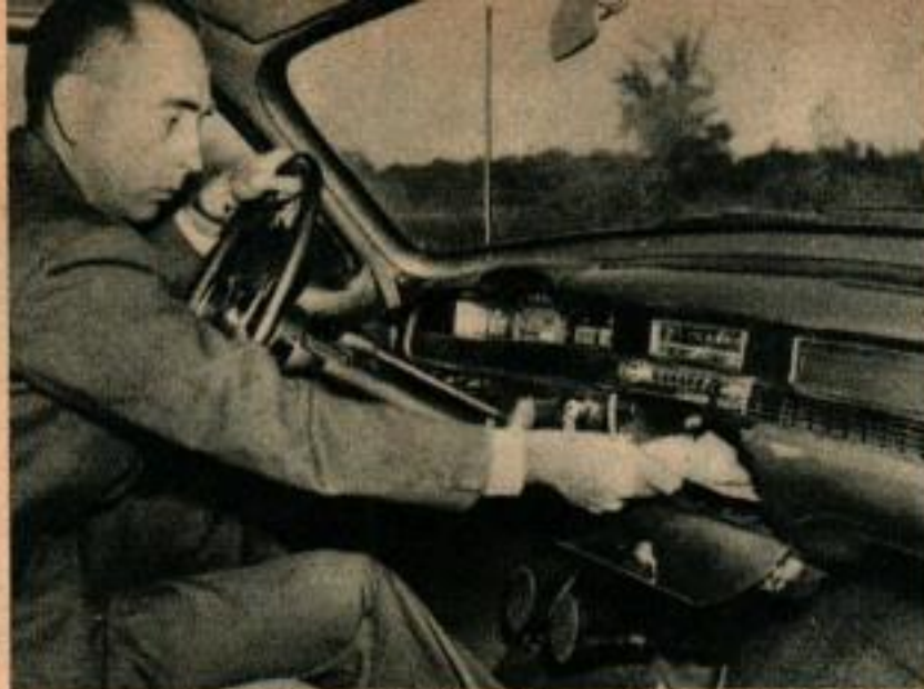
Le vide-poche a été installé au milieu du tableau de bord, à bonne portée de la main du chauffeur.
