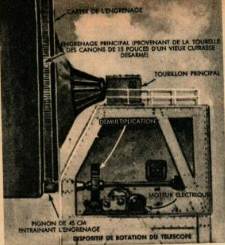
Ce réducteur de grande précision, à gauche, fait pivoter le réflecteur. A droite, un radar et des caméras enregistreront les observations.
