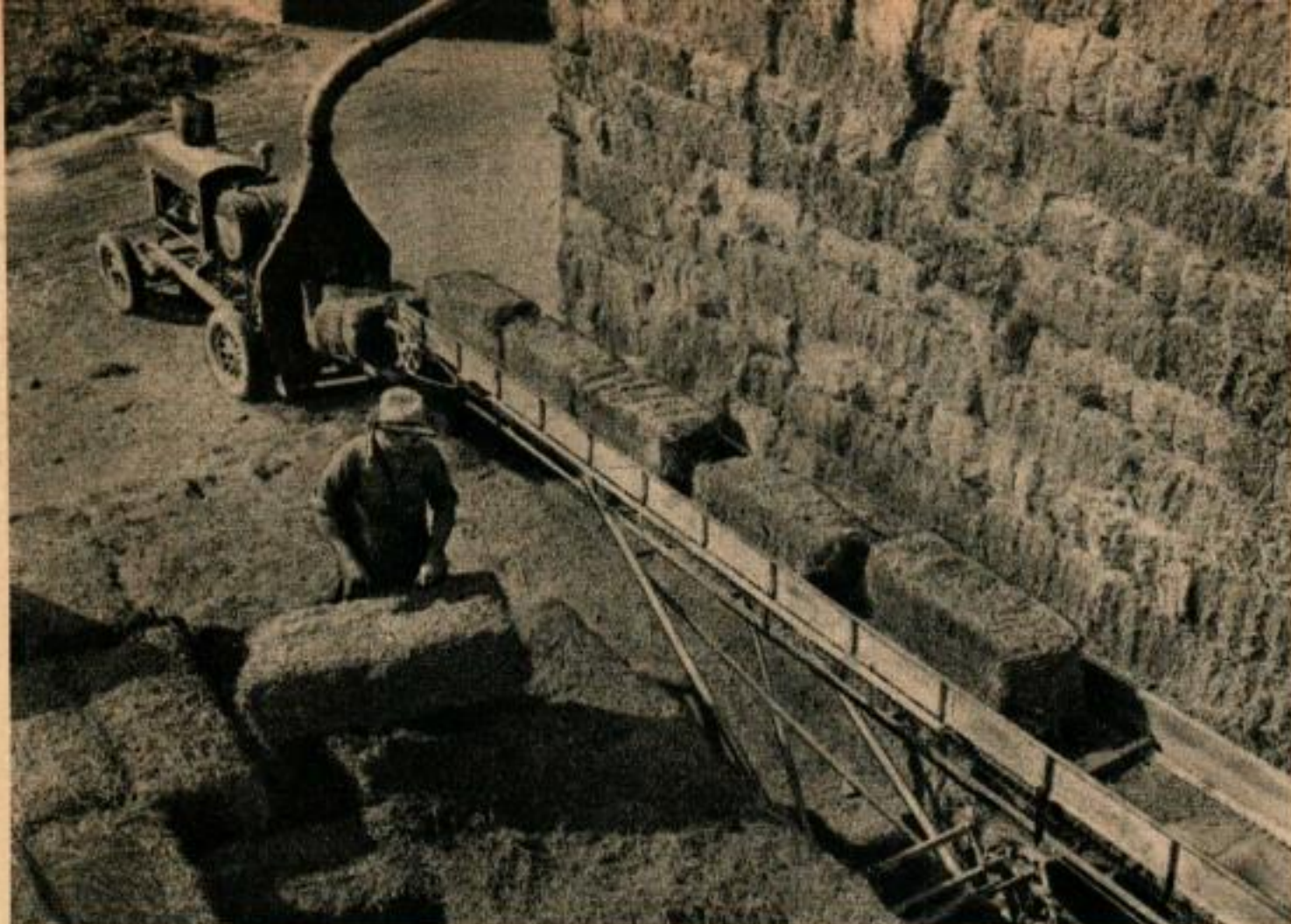
Cet élévateur peut fonctionner en marche arrière aussi bien qu'en marche avant, ce qui permet de descendre les balles de foin de la meule où elles étaient entreposées.
