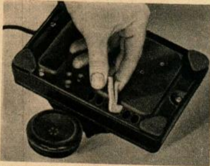
Ce silencieux adapté à la sonnerie d'un téléphone transforme son bruit strident en un bourdonnement.
