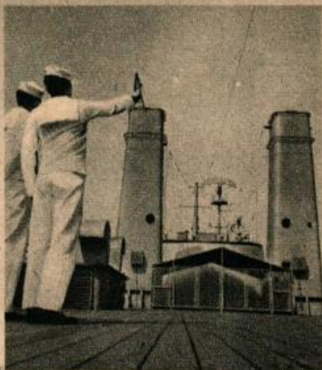
Ces cheminées à l'allure bizarre dispersent la fumée dans l'atmosphère et sont conçues pour atténuer les effets d'une explosion atomique.
