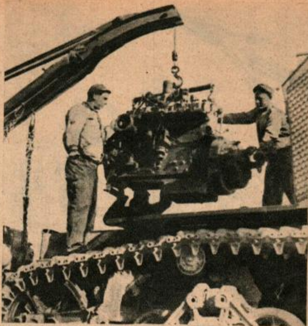
Mise en place d'un moteur reconstruit pour remise en route rapide d'un tank.
