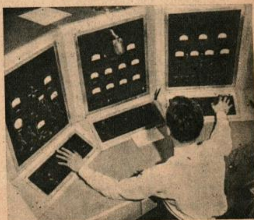
Mesure de la rapidité d'absorption par des plants de tomates alimentés par des éléments radioactifs. Ci-dessous, tableau de commande d'un cyclotron, isolé par de l'eau et du béton.
