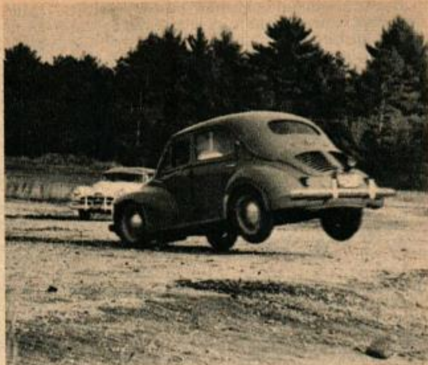
Au cours d'un essai sur les terrains d'expériences du M.V.R., une 4 CV Renault franchit un fossé; après cet essai, les roues avant n'étaient pas voilées.
