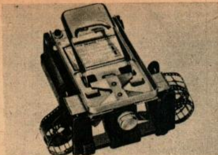
Le prix de revient est abaissé par un nouvel appareil qui prend 69 paires de photos sur une bobine. L'appareil ci-dessus découpe automatiquement les photos jumelles qui sont ensuite montées sur un disque (ci-dessus) et regardées à l'aide d'un viseur.
