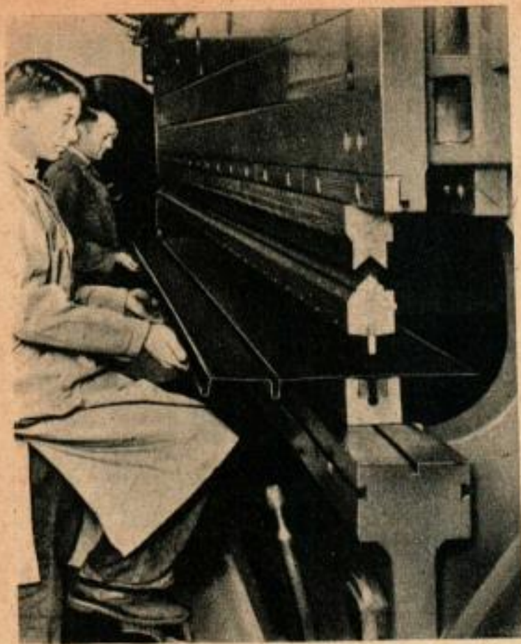
Cette machine emboutit une tôle de toiture dans une plaque d'acier. Elle travaille à grande vitesse façonnant une arête en haut et des côtes en bas.
