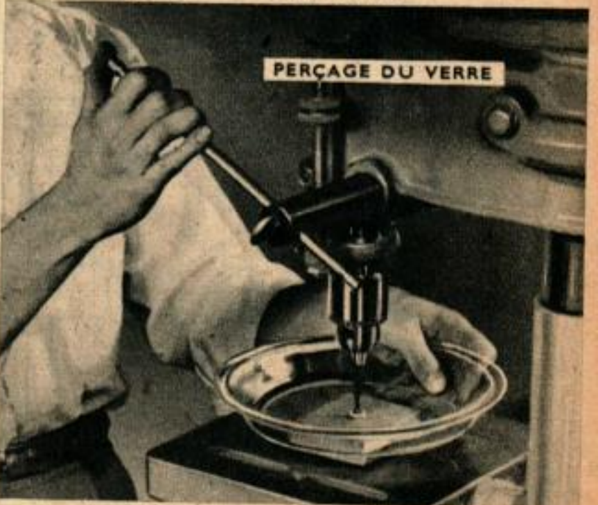
Ci-dessus, grattoir à lame munie d'une mise rapportée en carbure dur: l'on n'a plus besoin d'un réaffûtage continu. Ci-dessous, perçage du verre sur une perceuse dont le foret est une tige d'acier sur laquelle on a soudé une mise de forme convenable: on perce, le verre, la fibre, etc.
