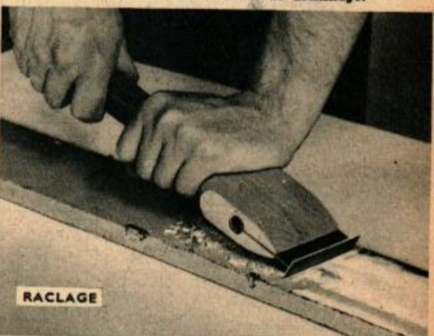
Ci-dessus, grattoir à lame munie d'une mise rapportée en carbure dur: l'on n'a plus besoin d'un réaffûtage continu. Ci-dessous, perçage du verre sur une perceuse dont le foret est une tige d'acier sur laquelle on a soudé une mise de forme convenable: on perce, le verre, la fibre, etc.
