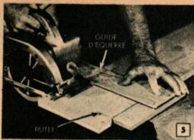
Le guide d'équerre est commode pour scier en travers. Le guidage donne une coupe plus franche.
