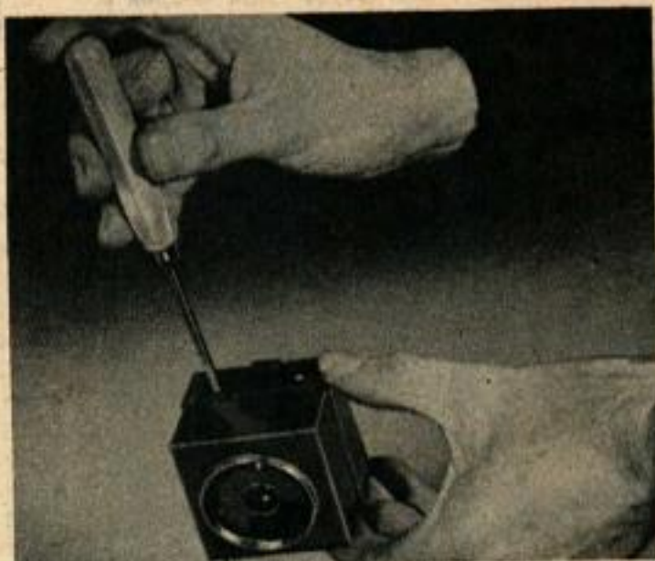
Ci-dessus, blocage des vis servant à solidariser les deux moitiés de l'appareil à reproduire. Les tiges des vis passent dans les encoches faites sur le pourtour de la rondelle (détail en haut et à gauche de la page). Ci-dessous, les pattes pliées et soudées servent de crampons pour maintenir le cliché sur le fond de la boîte.
