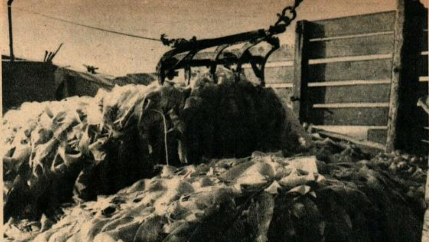
La griffe géante déplace facilement une demi-tonne d'algues à la fois et atteint toute partie de la cale.
