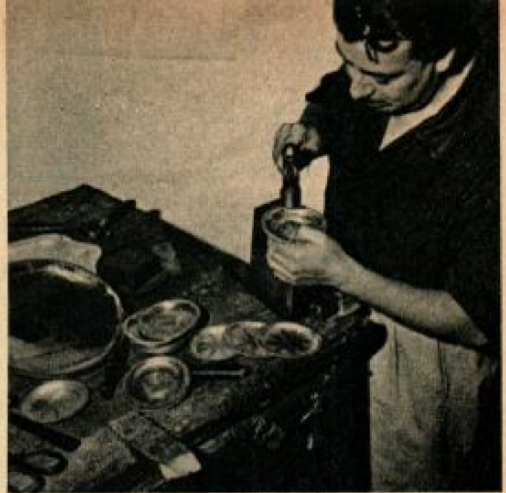
Les « métaux mariés » se font avec une base d'argent incrustée de cuivre ou de bronze et martelée.
