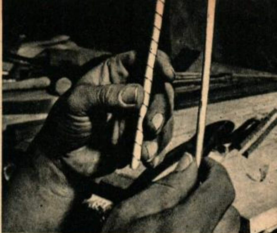
Pour faire les anneaux destinés aux oreilles et au nez d'un masque, un artisan enroule une bande de métal autour d'une tige, puis l'enlève et la courbe à la forme voulue.
