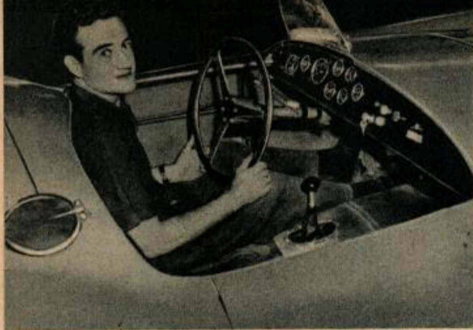
Briggs Cunningham au volant de son nouveau chef-d'œuvre, la C-4R. Le volant de sûreté cède en cas de collision. Ci-dessous: le coureur Phil Walters montre les ailettes du radiateur, qui enverront un courant d'air sur le tambour de frein.
