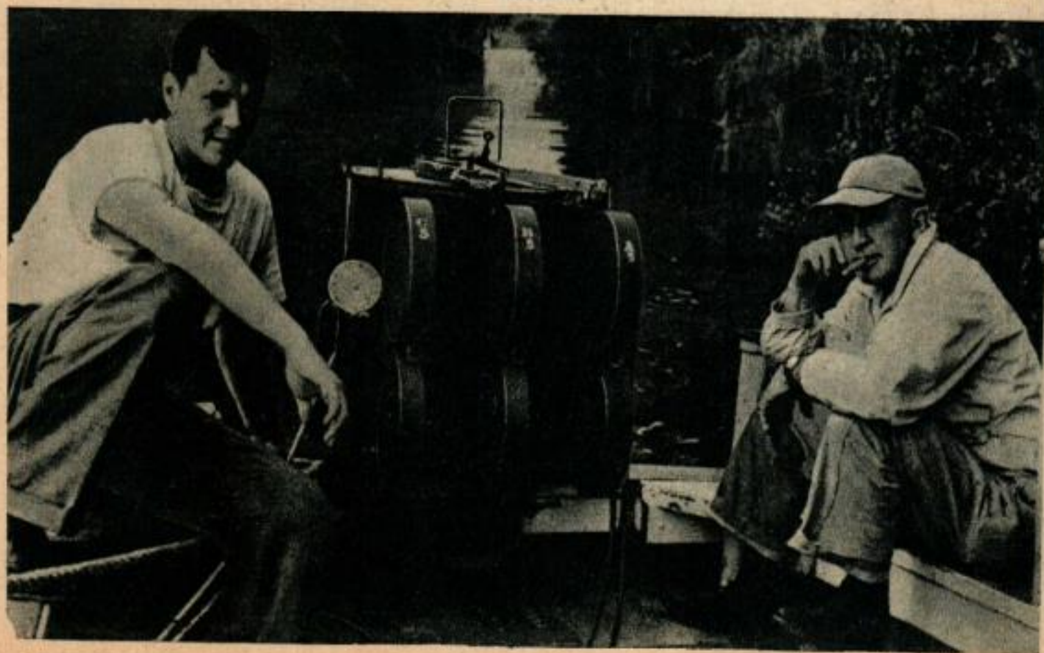
Vue arrière de l'appareil de prise de vues montrant les 3 magasins contenant les films impressionnés simultanément.
