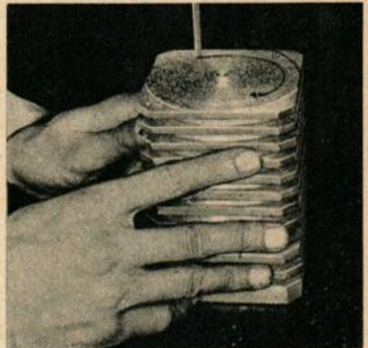
Le montage des lentilles peut se tourner dans du laiton ou de l'aluminium, à moins qu'on n'achète le condenseur tout fait. Le prix de revient est sensiblement le même.
