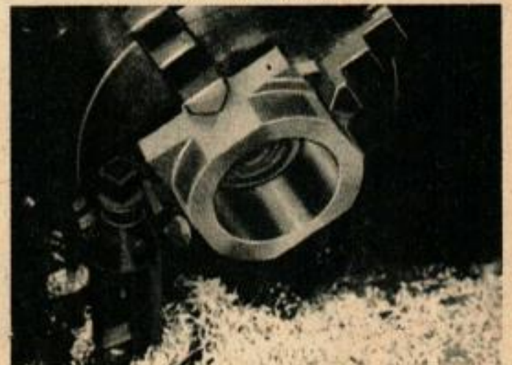
Le montage des lentilles peut se tourner dans du laiton ou de l'aluminium, à moins qu'on n'achète le condenseur tout fait. Le prix de revient est sensiblement le même.
