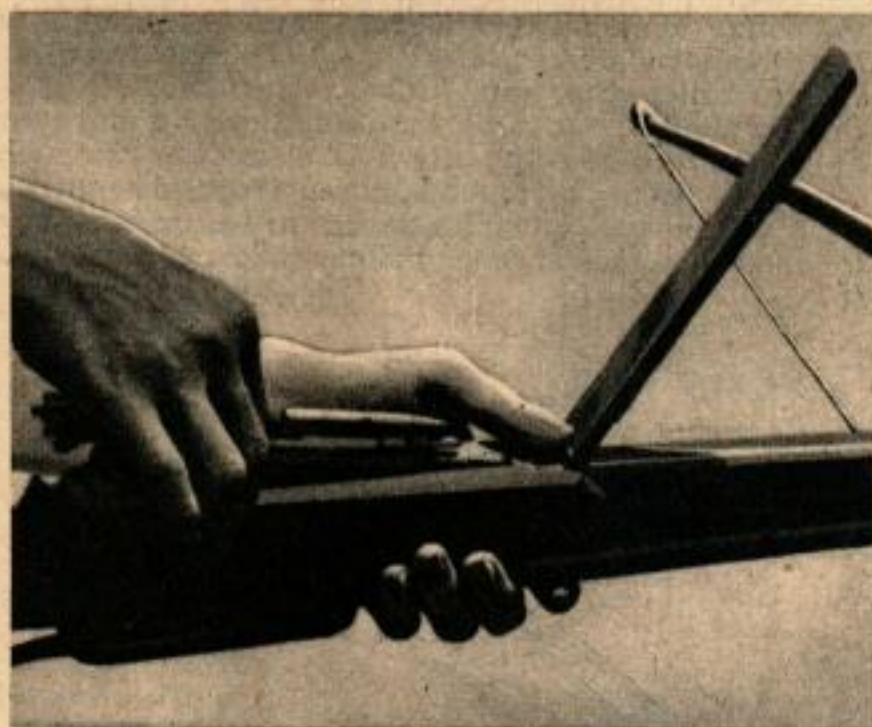
Ci-dessus, chargement du magasin de l'arbalète, de la même manière qu'avec un fusil, la charge comporte 5 flèches. Ci-dessous remarquer l'aspect de l'arme terminée. On achève par la mise en place d'un repère à l'extrémité du canon pour faciliter la visée.
