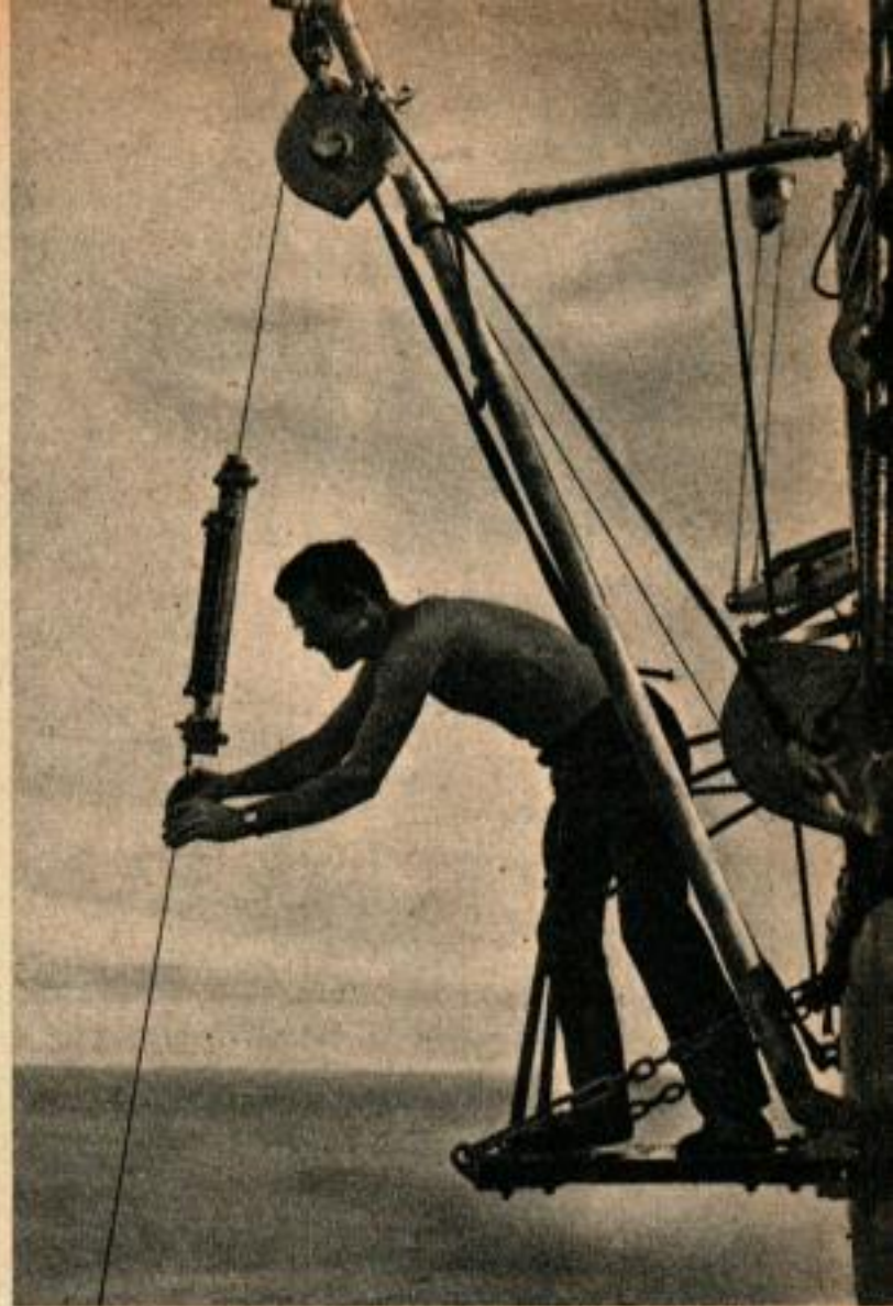
Un marin relève un appareil Ekman qui mesure les courants. L'hélice indique la vitesse du courant, les plombs placés dans le fond de l'instrument indiquent la direction.
