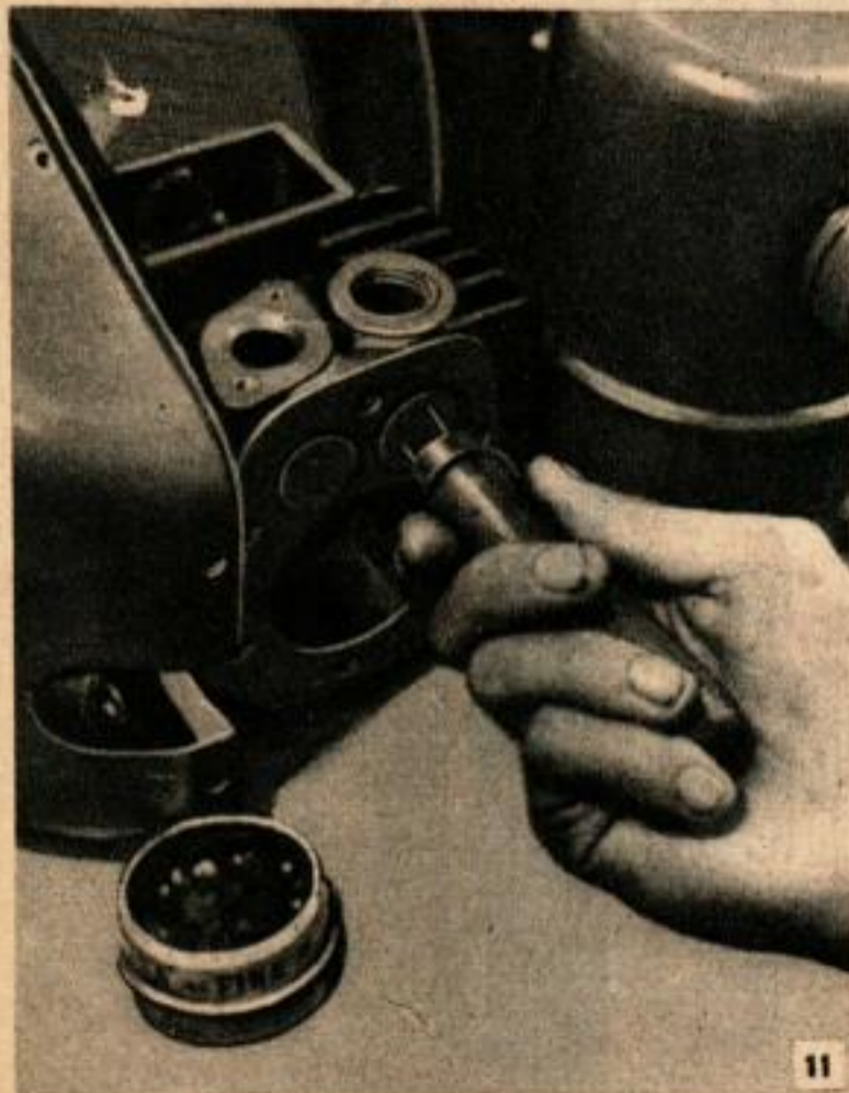
Ci-dessus et ci-dessous, nettoyage du carburateur et rodage des soupapes, deux opérations importantes dans l'entretien d'un moteur, surtout s'il est ancien et a rempli un service assez dur pendant de longues périodes.
