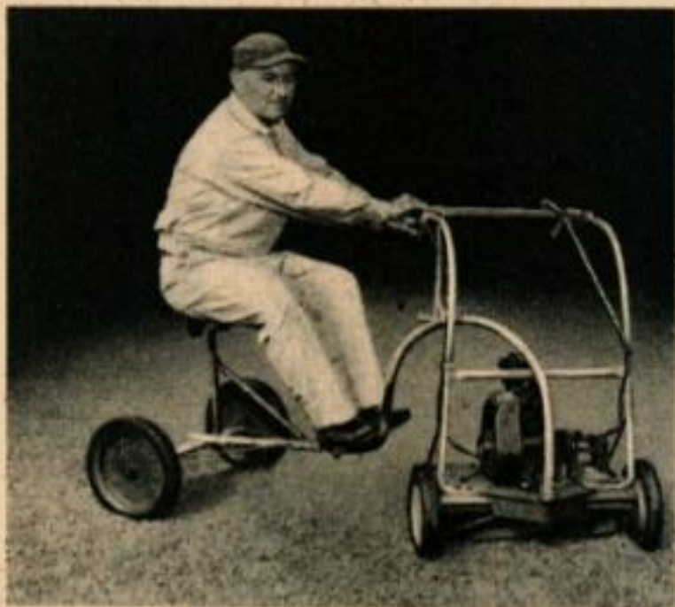
La machine tourne sur sa propre longueur, ce qui est une condition essentielle du fonctionnement de la tondeuse lorsqu'on veut travailler au voisinage de massifs de fleurs ou de parties de terrain à contour irrégulier.
