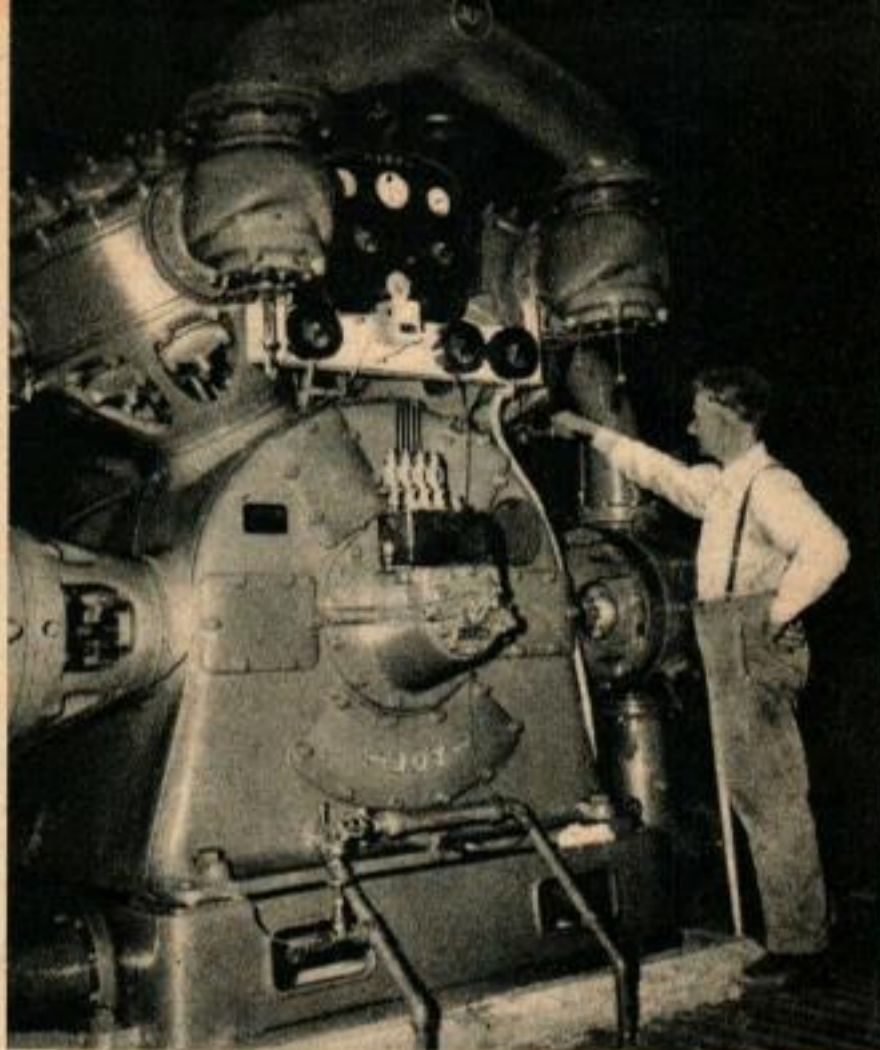
Les outils pneumatiques servant dans la mine à grande profondeur, nécessitent beaucoup d'air comprimé et la machine ci-dessus le fournit. Le tunnel de la mine a 2 kilomètres de long.
