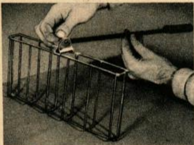
Ce grille-tartines permet de griller 2 tranches de pain à la fois. Le pivot est une goupille fendue attachée à un fil de fer et qui permet un démontage facile.
