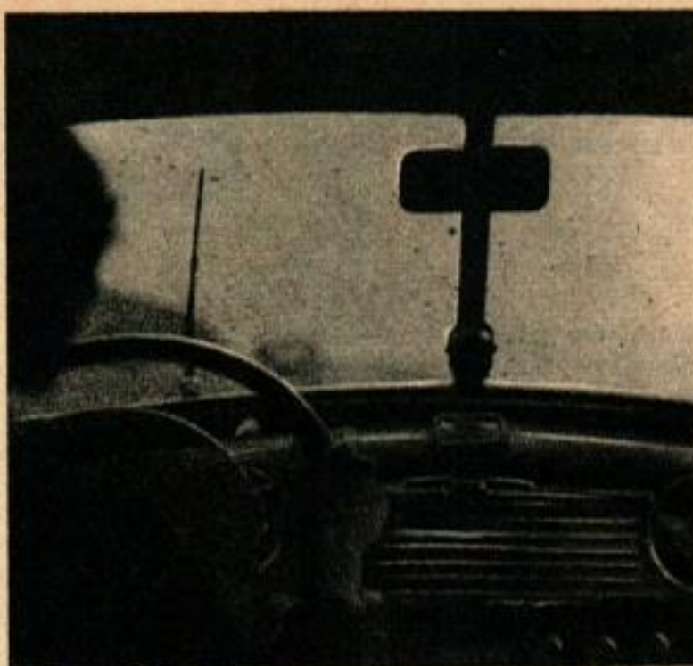
Les essuie-glaces actionnés par l'aspiration s'arrêtent quand le moteur est à bout de souffle dans une longue montée. La solution réside dans l'emploi d'essuie-glaces électriques.
