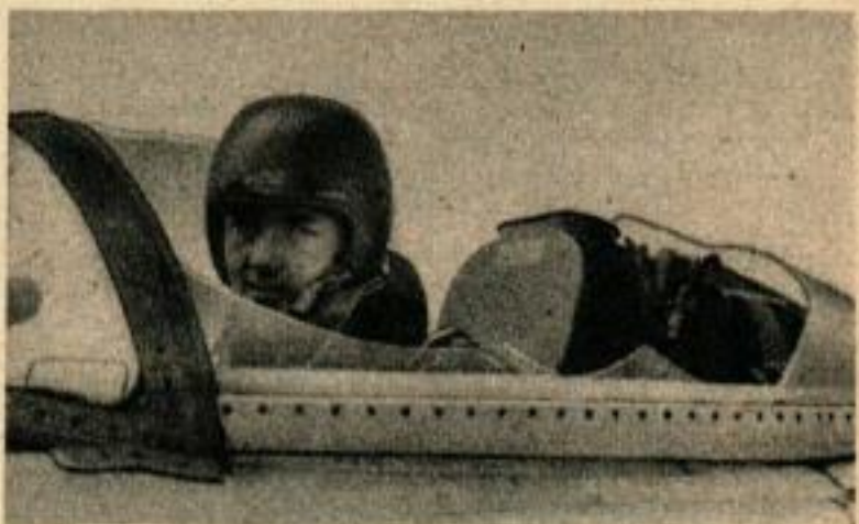
Ci-dessus, après cette avarie due à la D.C.A. le Mustang rejoignit sa base sans encombre. Ci-dessous, quand le pilote revint, la coupole manquait: il l'avait perdue en heurtant des fils électriques lors d'une attaque en rase-mottes — en bas.
