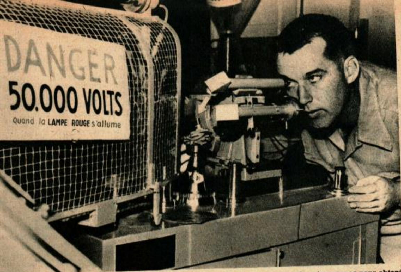
Le cristal d'acide aminé est monté sur la courte tige (flèche) et aligné au moyen de microscopes pour obtenir des photos par diffraction de rayons X.
