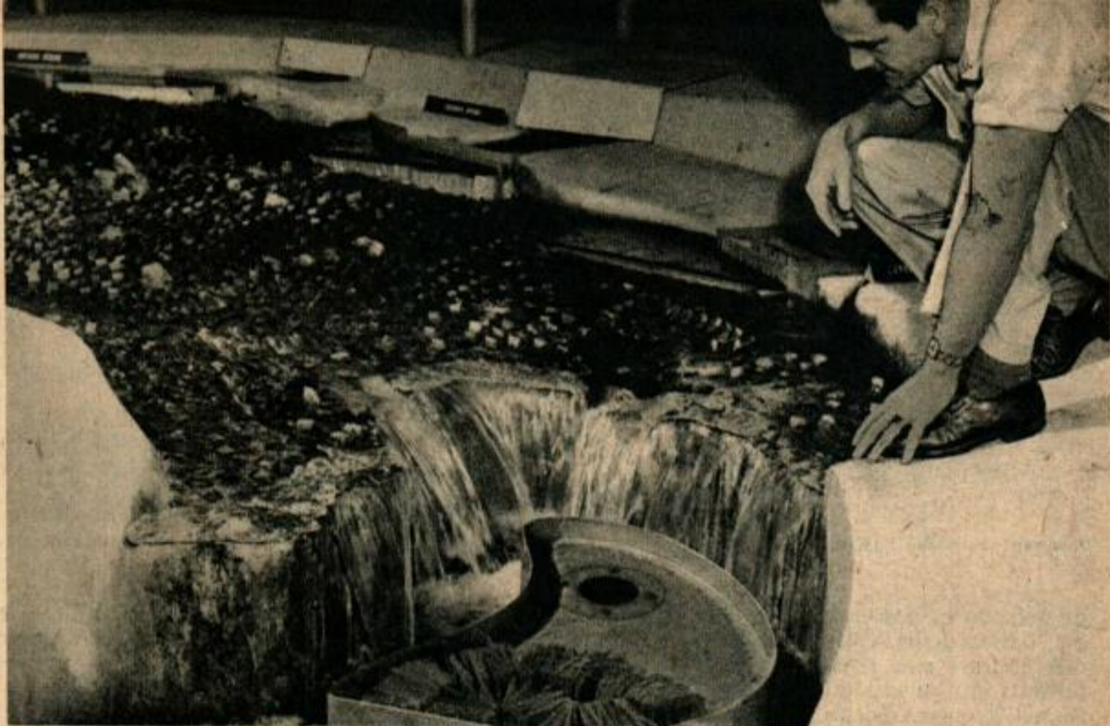
Les ingénieurs se servent d'une maquette du Niagara pour voir comment l'on peut mieux utiliser ses eaux grondantes.
