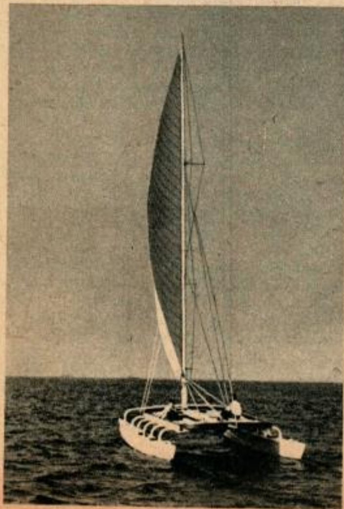
La légèreté est assurée par deux pontons minces qui fendent l'eau presque sans résistance. Ci-dessous, le pont large et haut forme une plate-forme stable pour suivre les courses.
