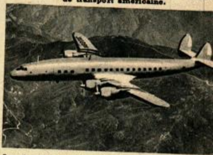
Les derniers modèles du gracieux Lockheed Constellation, ci-dessus, ont une vitesse de croisière de plus de 530 km à l'heure.
