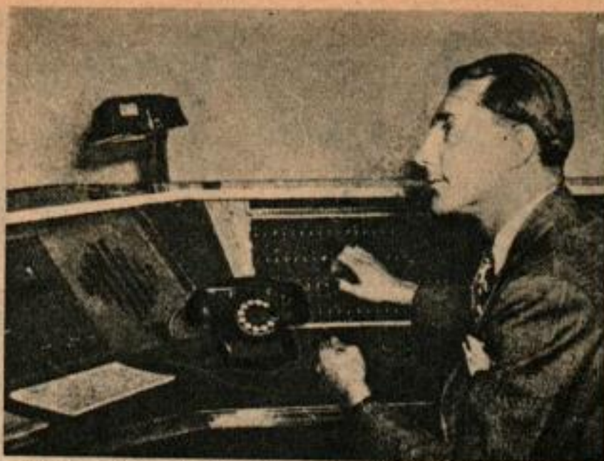
Les fiches de ce tableau commandent 500 points lumineux sur une carte murale qui permet de contrôler la position de chaque voiture de patrouille.
