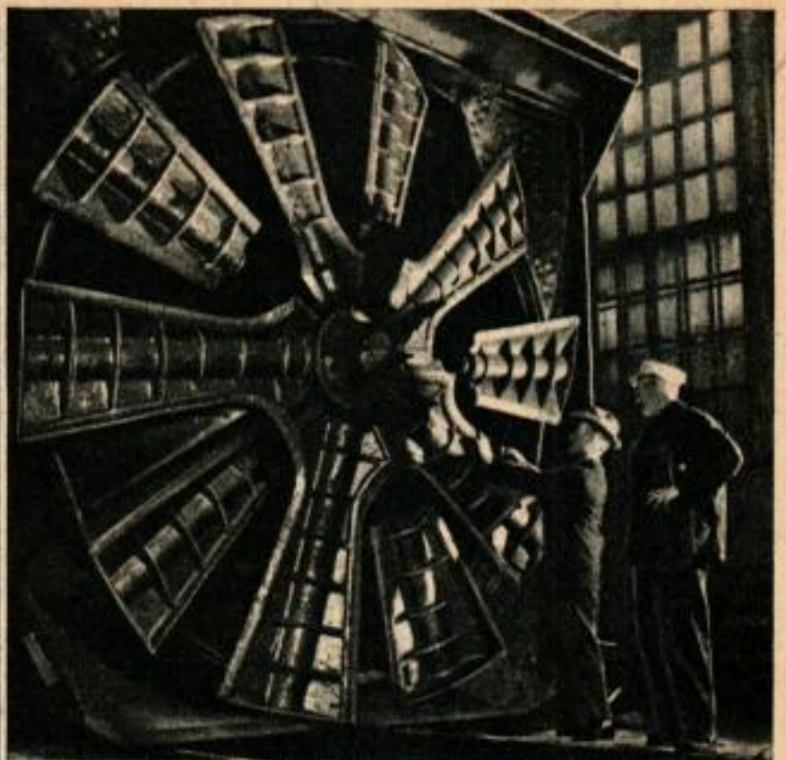
Le chef mécanicien explique les perfectionnements envisagés sur le chasse-neige rotatif.
