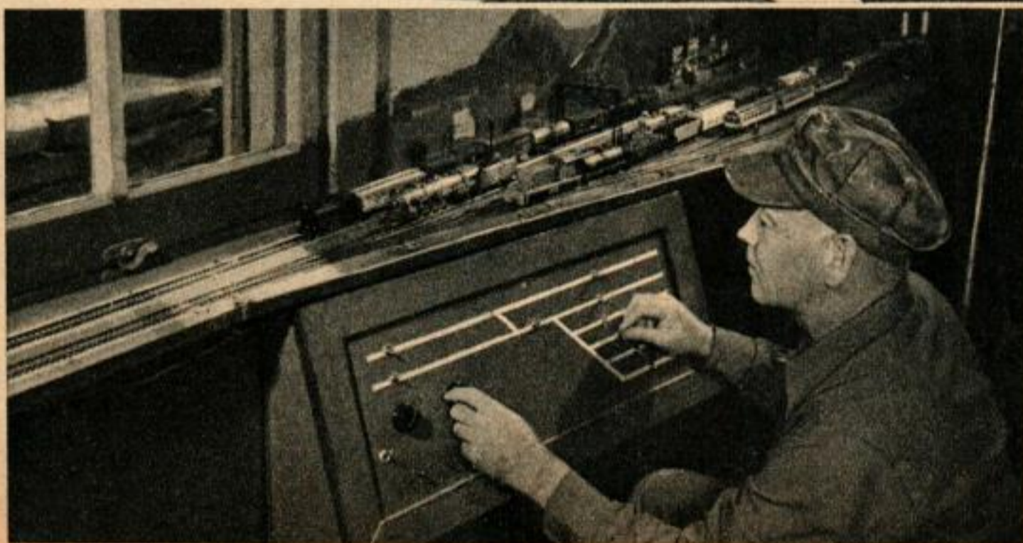
Ci-dessous, le tableau de commandes est situé juste au-dessous de la gare de triage à quatre voies. Tous les fils passent sous les voies.
