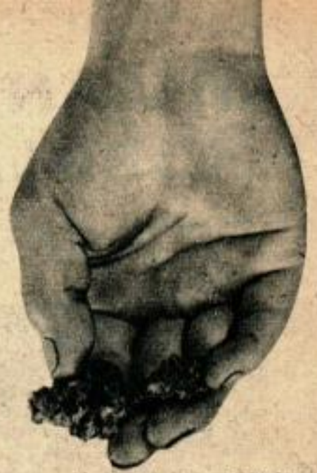
De grandes pelles mordent la roche qui produira du fer. Cidessus, la taconite peut être fondue en cylindres au lieu de l'être en billes.
