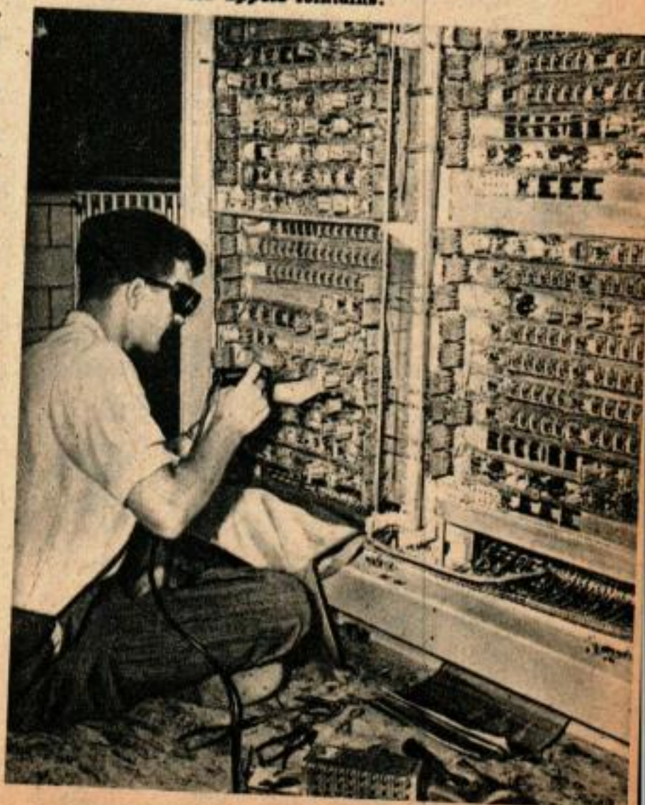
Le tableau ci-dessus surveille tout appel à longue distance, poinçonnant une fiche de renseignement. L'enregistreur, ci-dessous est muni de relais pour les appels lointains.
