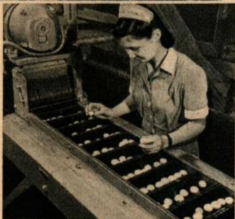
Pas assez belles pour être vendues comme boutons, ces têtes de champignons sont lavées; puis, on les met dans une machine, à gauche, qui les coupe en tranches avant la mise en boîte.
