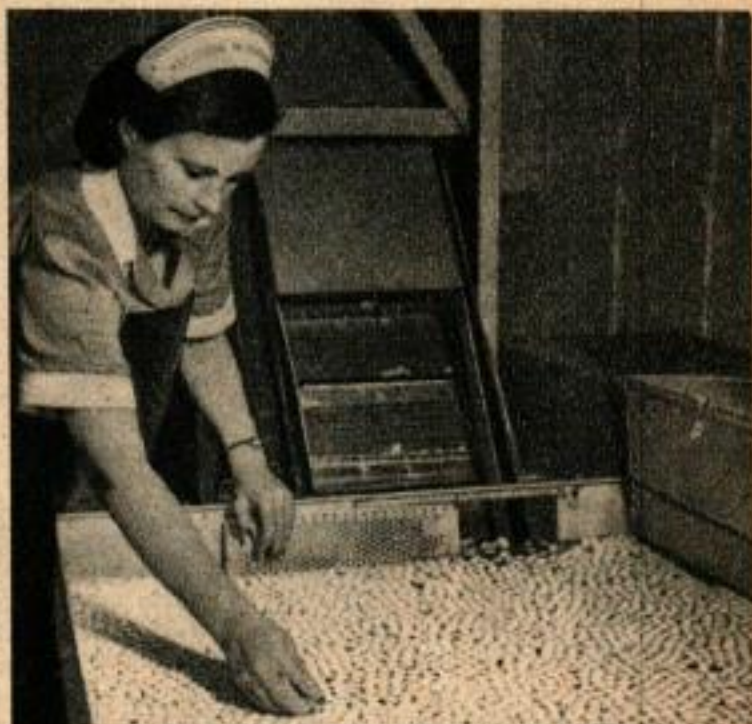
Les champignons sont transportés d'une machine à l'autre par des courroies sans fin. Le triage se fait, comme ici, pendant qu'ils flottent dans des réservoirs. Ce sont ici des boutons de première qualité.
