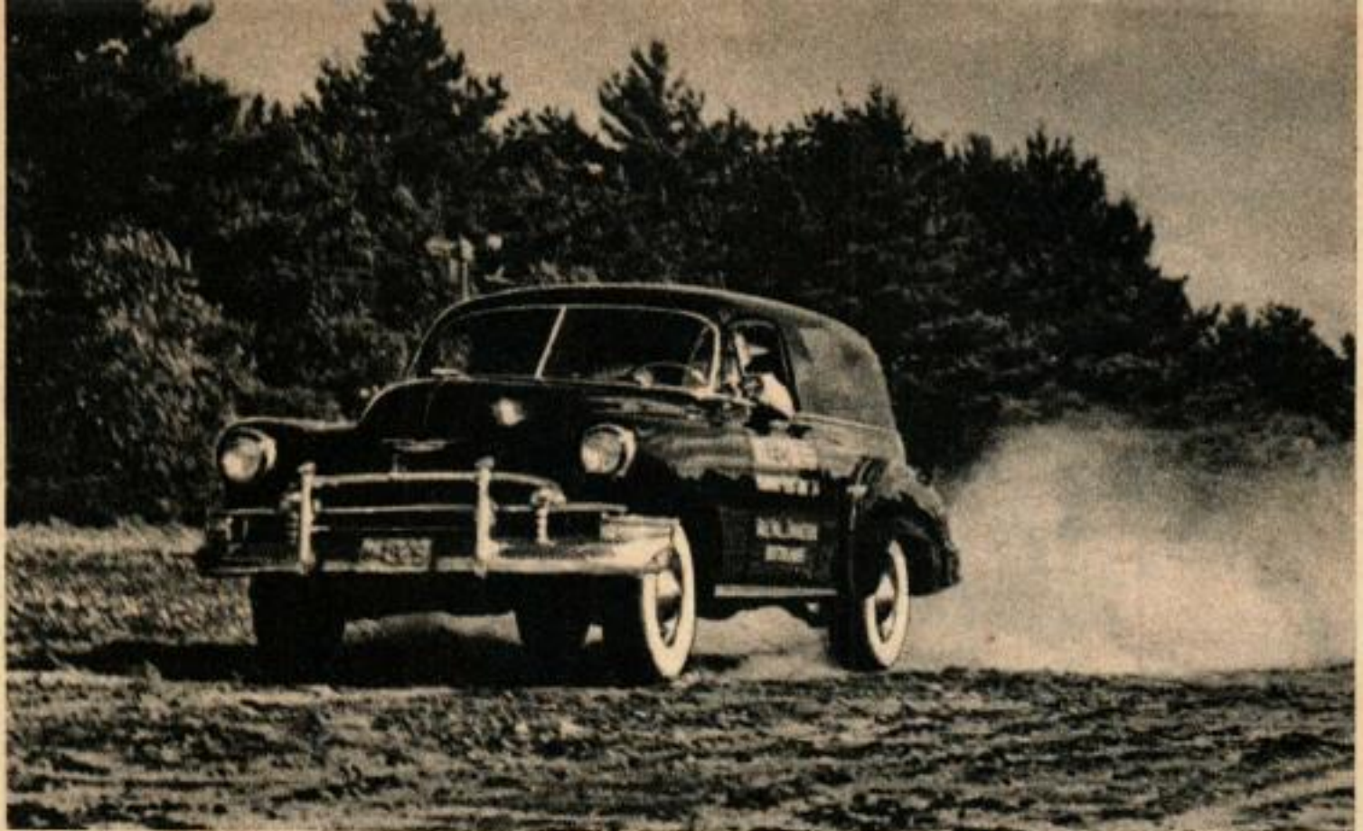
Ce camion d'expériences contient 308 instruments qui montrent exactement ce qui se produit dans le châssis pendant le fonctionnement.
