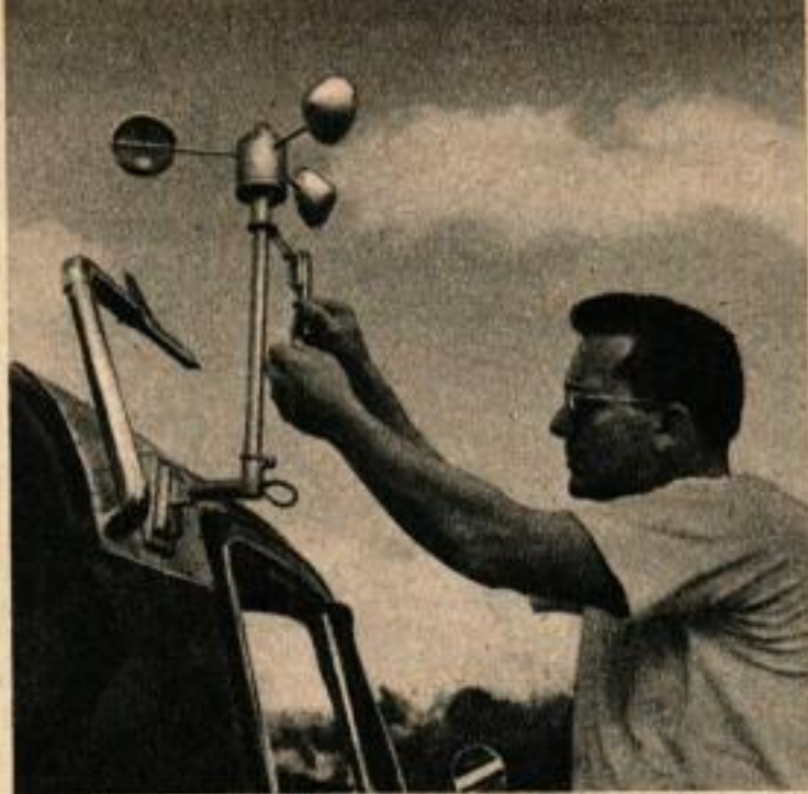
White mesure l'influence du vent sur la consommation de l'essence au moyen d'un tube de Pitot et d'un anémomètre montés sur la toiture.
