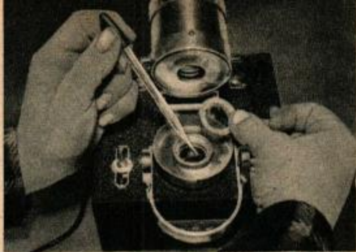
À tout moment de la course, White peut prélever un échantillon d'huile dans le carter ou la boîte de vitesses pour vérifier sa viscosité et son état au moyen d'un instrument spécial.
