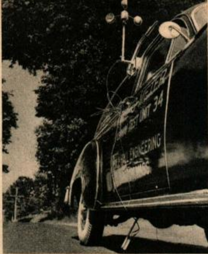
Les instruments extérieurs comprennent le tube de Pitot et l'anémomètre placés sur la toiture et, près du sol, un thermocouple, qui mesure la chaleur rayonnée par la route.
