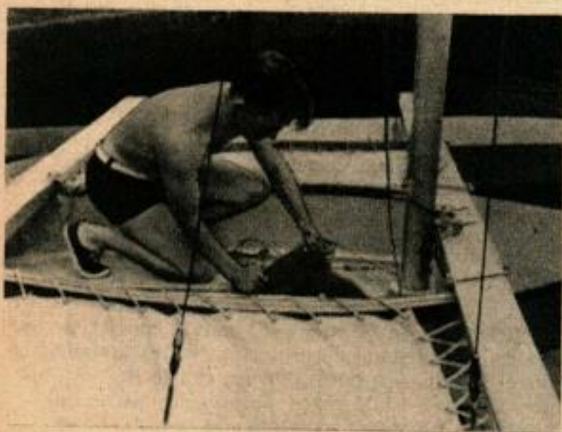
En soulevant la dérive en contreplaqué, ci-dessus, on diminue de quelques centimètres le tirant d'eau de la coque centrale. Ci-dessous, le bôme en aluminium est léger et facile à manier lorsqu'on veut y hisser la voile principale. Noter les haubans attachés sur le support du poste central.
