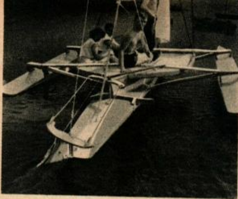
Ci-dessus, vue arrière du Trimaran, montrant le support à l'arrière du poste de pilotage. Ce support permet, en cas de besoin, de monter un moteur de hors-bord sur la partie droite de la coque centrale.
