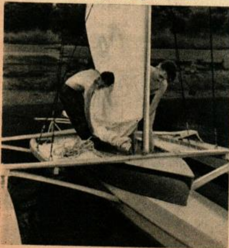
En soulevant la dérive en contreplaqué, ci-dessus, on diminue de quelques centimètres le tirant d'eau de la coque centrale. Ci-dessous, le bôme en aluminium est léger et facile à manier lorsqu'on veut y hisser la voile principale. Noter les haubans attachés sur le support du poste central.
