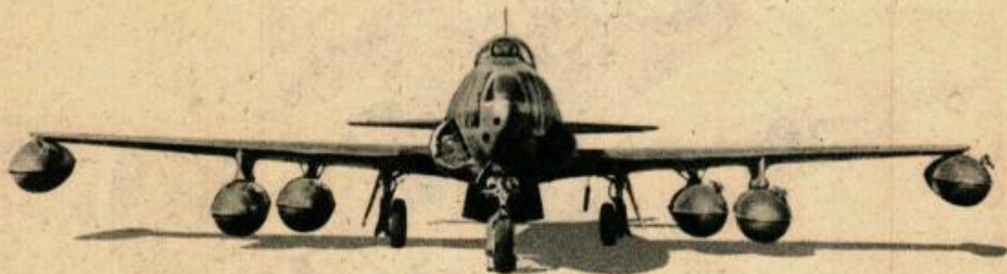
Six réservoirs de 400 litres d'essence « en gelée » augmentent la puissance destructive de ce F-80.
