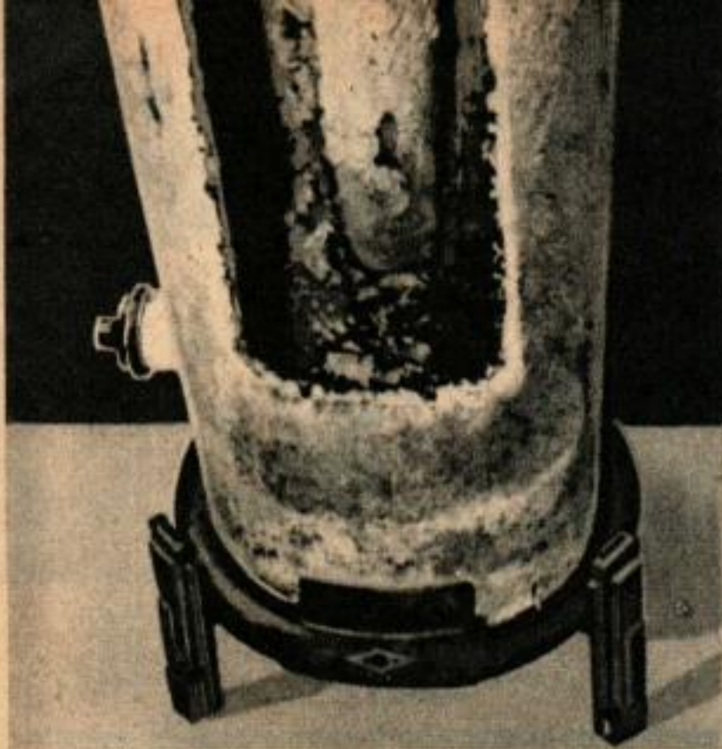
Vue en coupe d'une chaudière montrant les incrustations calcaires sur les parois et les dépôts au fond, dus à un emploi prolongé avec les eaux très dures.
