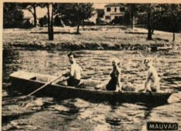
La photo de gauche montre une bonne répartition du poids à l'intérieur du bateau, ce qui assure une vitesse maximum et un pilotage sûr et efficace. Les charges placées trop vers l'avant rendent pénible le maniement des rames. En outre, le bateau risque d'embarquer de l'eau par l'avant.
